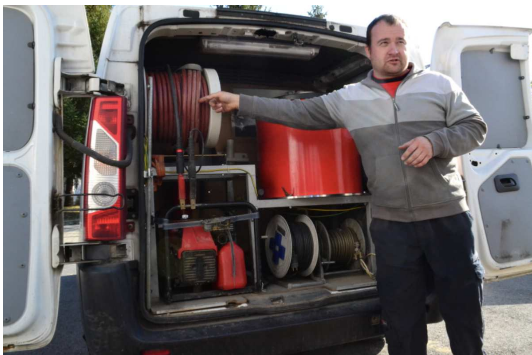
Obr.: Zásahové vozidlo pre poruchy zemných vodičov
